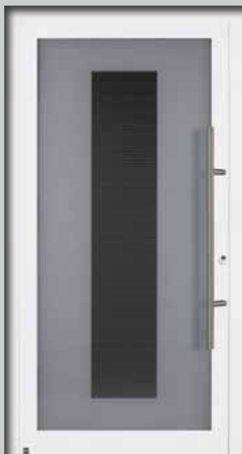
Wzór 100 / MG 112 Uchwyt 38-1 ze stali nierdzewnej, szyba zewnętrzna ze wzorem: matowane zespolone szkło bezpieczne z przezroczystym prostokątem, szyba środkowa: Micrograin, szyba wewnętrzna: przezroczyste zespolone szkło bezpieczne, współczynnik U_D nawet 1,6 W/(m 2 ·K)*
