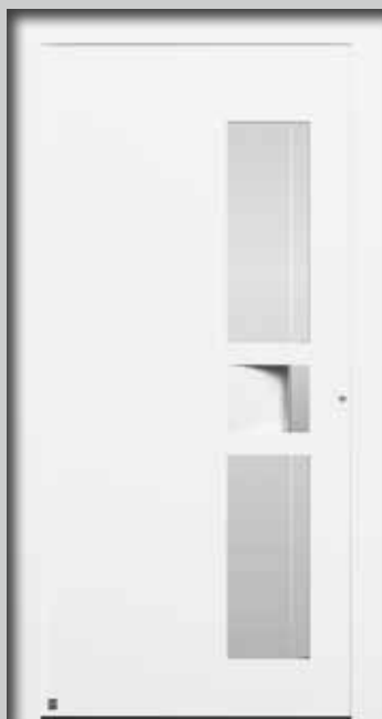
Wzór 312 Zlicowana listwa uchwytna standardowo w kolorze białego aluminium RAL 9006, półmat, zagłębienie pod uchwyt standardowo w kolorze drzwi, szyba ze wzorem – szkło Float matowane z jednym przezroczystym paskiem, 4-szybowe szkło izolacyjne, drzwi zalecane do domów pasywnych, współczynnik U_D nawet 0,57 \text{ W}/(\text{m}^2\cdot\text{K})^*
