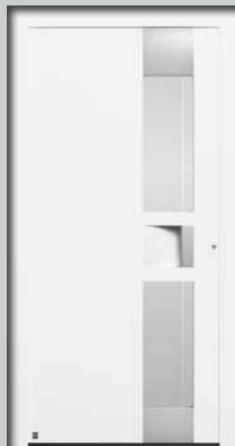
Wzór 302 Zlicowana listwa uchwytna standardowo w kolorze białego aluminium RAL 9006, półmat, zagłębienie pod uchwyt standardowo w kolorze drzwi, aplikacje ze stali nierdzewnej, szyba ze wzorem – szkło Float matowane z jednym przezroczystym paskiem, 4-szybowe szkło izolacyjne, drzwi zalecane do domów pasywnych, współczynnik U_D nawet 0,57 \text{ W}/(\text{m}^2\cdot\text{K})^*
