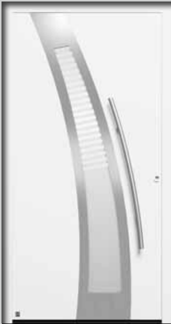
Wzór 40 Uchwyt HOE 550 ze stali nierdzewnej, szyba zewnętrzna z wzorem – częściowo matowane zespolone szkło bezpieczne, z paskami w górnej części, przezroczysta szyba środkowa Float z częściowo matowanymi paskami przesuniętymi w stosunku do szyby zewnętrznej, 3-szybowe szkło izolacyjne, współczynnik U_D nawet 1,1 \text{ W}/(\text{m}^2\cdot\text{K})^*
