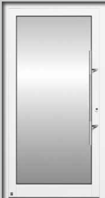
Wzór 100 Uchwyt 38-1 ze stali nierdzewnej, szkło ornamentowe Mastercarré, 3-szybowe szkło izolacyjne, współczynnik U_D nawet 1,3 W/(m 2 ·K)*
