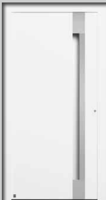
Wzór 308 Zlicowana listwa uchwytna standardowo w kolorze białego aluminium RAL 9006, półmat, zagłębienie pod uchwyt standardowo w kolorze drzwi, drzwi zalecane do domów pasywnych, współczynnik U_D nawet 0,51 \text{ W}/(\text{m}^2\cdot\text{K})^*
