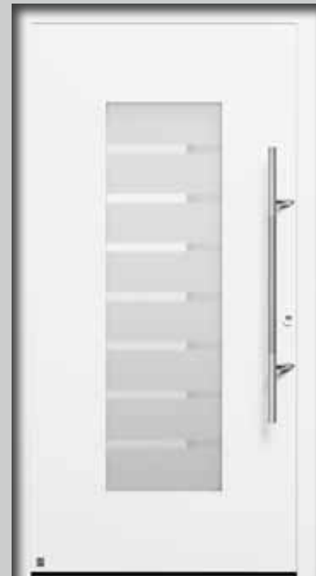
Wzór 136 Uchwyt 38-1 ze stali nierdzewnej, szyba ze wzorem – szkło Satinato z 7 matowanymi paskami, 3-szybowe szkło izolacyjne, współczynnik U_D nawet 1,1 \text{ W}/(\text{m}^2\cdot\text{K})^*
