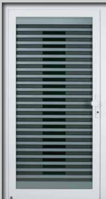
Wzór 100 / MG 113 Standardowy uchwyt 54 w formie gałki, szyba zewnętrzna ze wzorem: zespolone szkło bezpieczne z 25 matowanymi paskami, szyba środkowa: jednoszybowe szkło bezpieczne Stopsol szare z 26 matowanymi paskami, szyba wewnętrzna: przezroczyste zespolone szkło bezpieczne, współczynnik U_D nawet 1,6 W/(m 2 ·K)*
